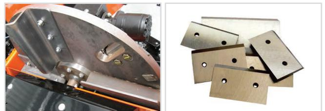
Rotor de 125 kg de peso perfectamente balanceado con 4 cuchillas reversibles.
