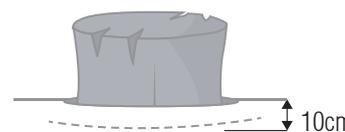
Fig. 3 Profundidad máxima de fresado
