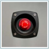
Parada de emergencia externa
