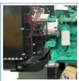
Alternador sin escobillas
