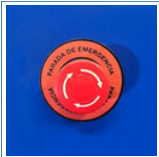
Parada de emergencia externa
