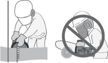
12. Mantenga todas las partes de su cuerpo alejadas de la máquina mientras el motor está en funcionamiento. Antes de arrancar el motor, asegúrese de que la cadena no esté en contacto con ningún objeto.
