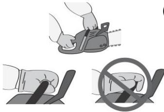
(1) Cuando el motor esté en funcionamiento sostenga firmemente la motosierra con ambas manos, la mano derecha sobre la empuñadura trasera y la mano izquierda sobre la empuñadura delantera. Coloque los dedos firmemente alrededor de las empuñaduras de la motosierra. Un agarre firme lo ayudará a mantener el control de la motosierra. No afloje sus manos mientras corta.
