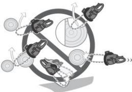
Las reacciones de la motosierra ocurren cuando la barra guía toca un objeto con la punta o cuando la madera se cierra y presiona la cadena en el corte.
